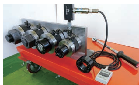
トルク・軸力の測定と、緩み試験の様子
