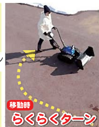
モーターが直接クローラーを駆動
