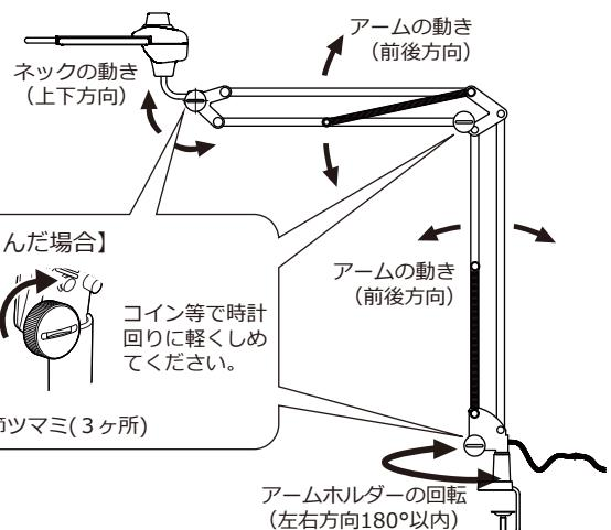
**お願い** アームを可動させる時は、ハンドルを持って可動させてください。ネック部を可動させる時は、調節ツマミ付近を押さえながらハンドルを持って可動させてください。
