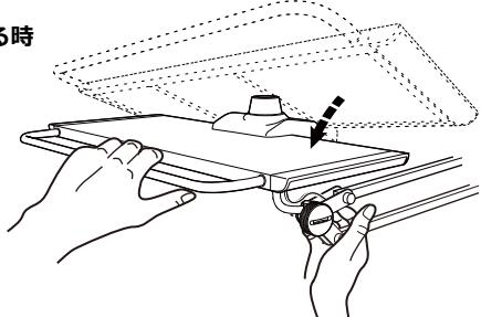
**禁止** 下図の使用回転範囲をこえた後方に、アームを回して使用しないでください。アームやセードなどの重みでクランプが不安定になり、落下した場合、火傷、ケガ、火災の原因になります。
