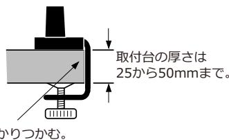
**禁止** 下図のような《不安定な取り付け》はしないでください。落下した場合、火傷、ケガ、火災の原因になります。
