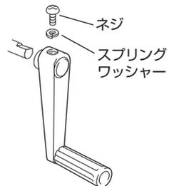
付属のハンドルをネジとスプリングワッシャーを使用して図のように取り付けてください。
