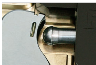
特許：球形ピストンシステム
